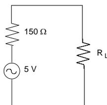
2.9. En el circuito de la figura, calcular  $V_L$  en voltios y dBV, así como  $P_L$  en vatios, dBW y dBm para valores de  $R_L$  de 10, 50, 100, 150, 300, 600, 1K, 10K y 100 K ohms. Construya una gráfica del voltaje y la potencia en unidades fundamentales y logarítmicas (dB) y explique su significado, relacionán-dolo con el teorema de máxima transferencia de potencia.
