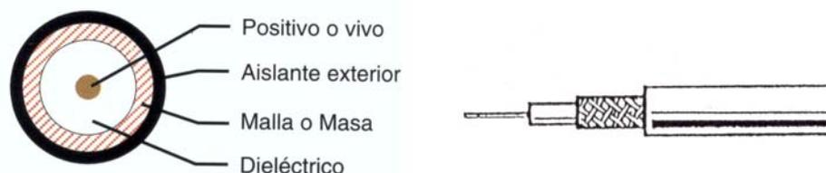
Para un cable normal la atenuación suele ser del orden de 0,35 dB por metro y para cable de calidad de 0,25 dB por metro.
