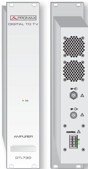
El **DT-730** es un amplificador de potencia RF de 1 W de alta calidad para señales COFDM, para sistemas de portadora única o multiportadora (\*). El sistema ofrece una salida amplificada de 30 dBm (137 dB $\mu$ V). Ésta es una solución de alta calidad que conserva la calidad de la señal original y mantiene los niveles de ruido bajos.
